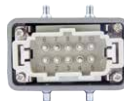
Clavija completa de Poder / Termopar HEMBRA de 10 pines ,2 hileras (incluye glándula, inserto hembra y capota de "2 ganchos")
