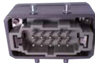
Clavija completa de Poder / Termopar MACHO de 10 pines ,2 hileras (incluye glándula, inserto macho y capota de "2 ganchos")
