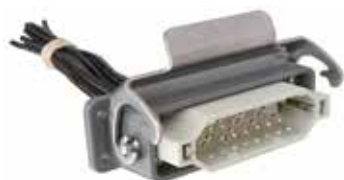
Base receptora completa MACHO de 24 pines, 3 hileras (incluye inserto macho, ponchable y base de "1 gancho")
