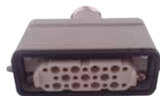
Clavija completa de Poder / Termopar HEMBRA de 24 pines , 3 hileras (incluye glándula, ponchable, inserto hembra y capota de "1 gancho")
